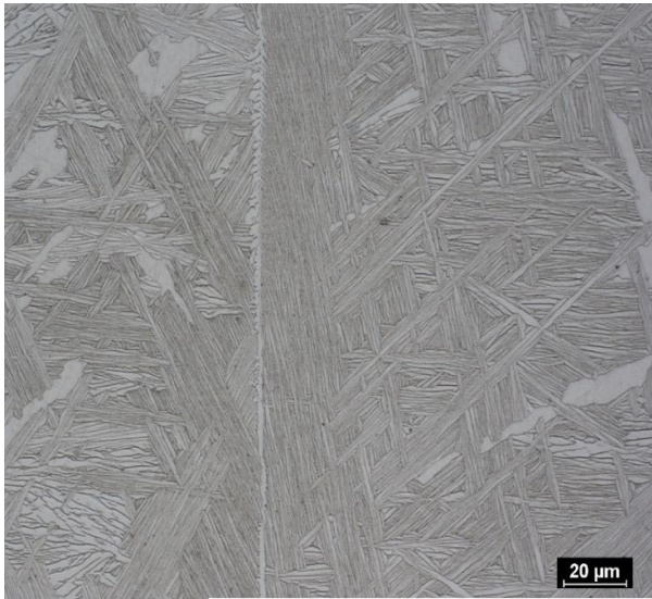
Obrázek 34: Netvářený vzorek – podélný řez ve zvětšení 50x8: a) s hranicí zrna; b) bez hranice zrna
