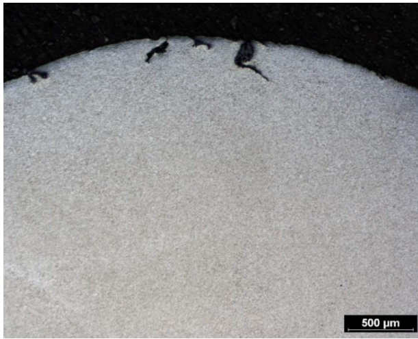
Obrázek 26: Mikrostruktura příčného řezu tvářeného vzorku s menším zvětšením
