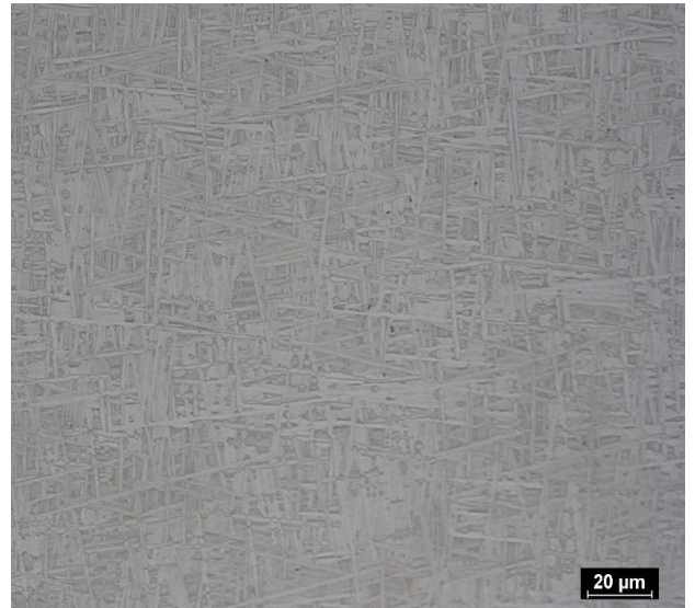
Obrázek 32: Netvářený vzorek – příčný řez ve zvětšení 50x8: a) s hranicí zrna; b) bez hranice zrna
