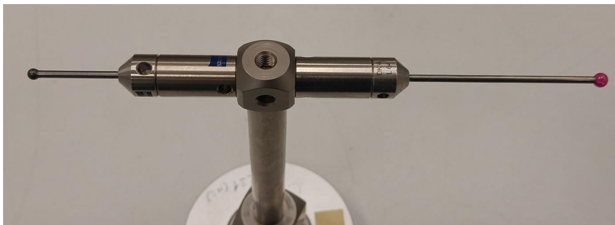
Obr. 29: Fotografie použité sondy: dřík 22 mm s kuličkou \varnothing 3 mm (nalevo) a dřík 55 mm s kuličkou \varnothing 4 mm (napravo)
