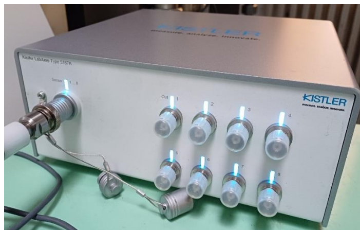
Obrázek 19 Zesilovač náboje LabAmp s DAQ 5167A
