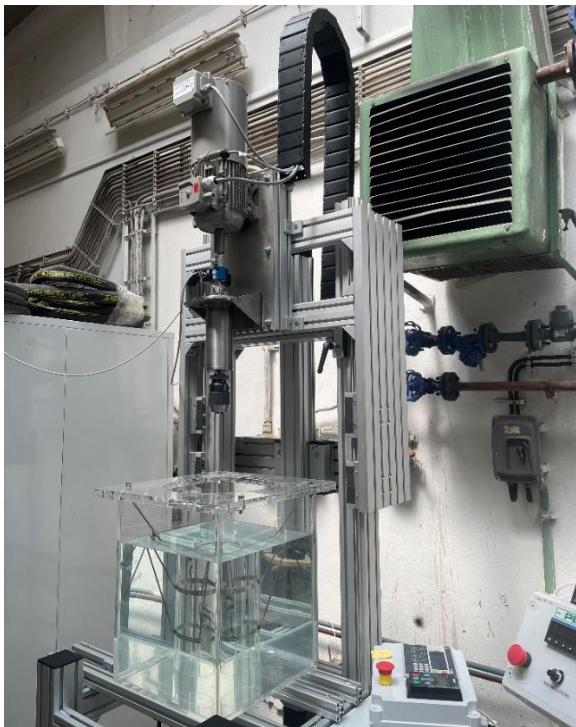
Obrázek 21 - měřicí stanice pro příkonová čísla
