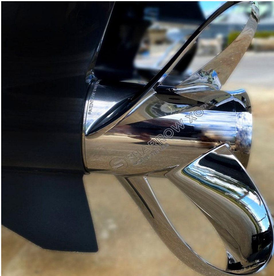
Obrázek 7 - toroidní vrtule využita jako lodní šroub [9]
