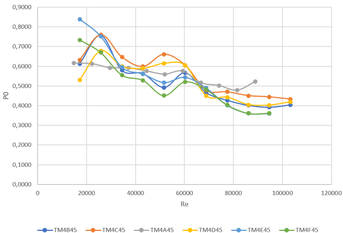
Obrázek 35 - příkonové charakteristiky druhé generace míchadel v aplikaci bez narážek
