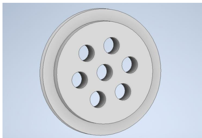
Obrázek 35- Více děrová průtočná deska 7 děr
