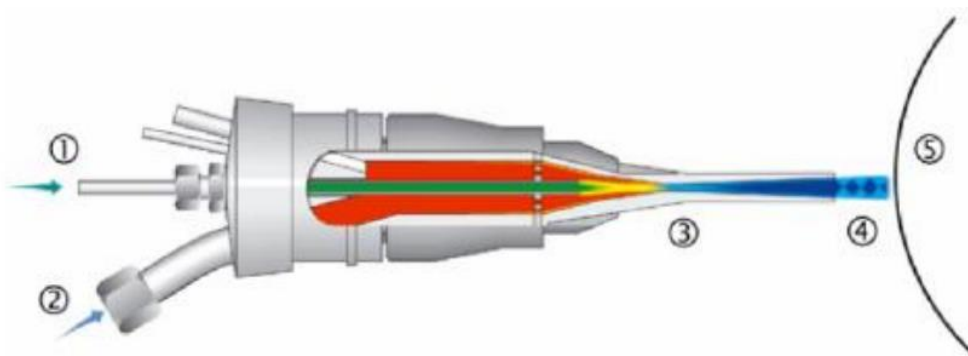
Obrázek 11-schéma stříkací pistole pro nástřik studeným plynem: 1) přívod přídavného materiálu, 2) přívod ohřátého plynu, 3) tryska ve tvaru Lavalovy dýzy, 4) proud urychlených částic, 5) základní materiál [8]
