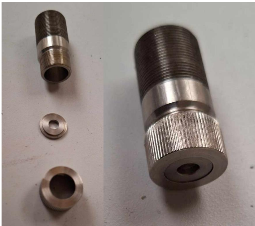
Obrázek 31- Nová tryska – před montáží (vlevo) a po montáží (vpravo)
