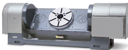
Obr. 2.12 Otočný stůl s kolébkou [15]
