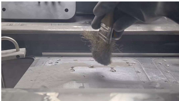
Obrázek 26 - Zametení prášku do odpadu
