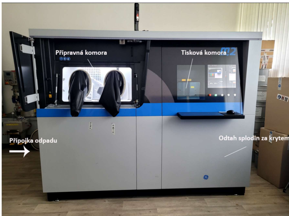
Obrázek 21 - Orientační schéma tiskárny
