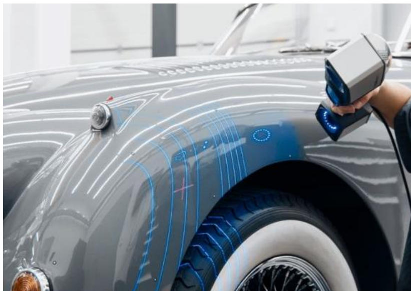
Obrázek 11 – Ukázka měření s T-SCAN hawk 2 na lesklém povrchu [17]
