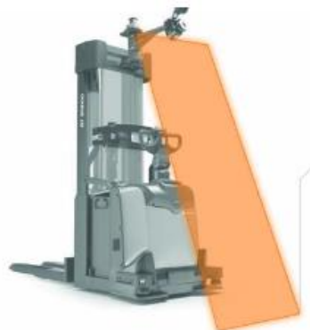
Obrázek 10: Čelní detekce překážek nad úrovní podlahy [18]
