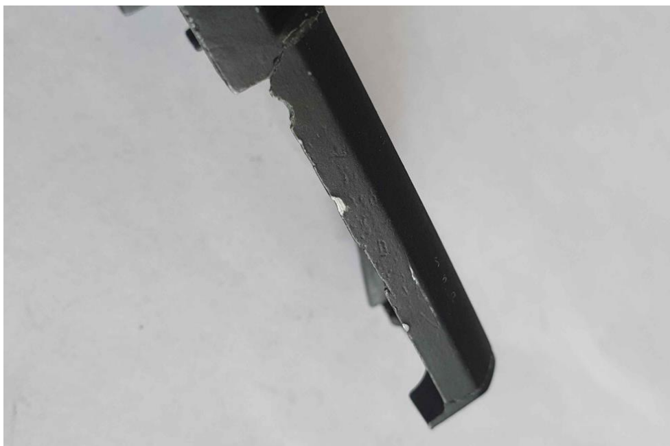
Obrázek 9 – Vruby na ostré hraně konstrukce převodovky
