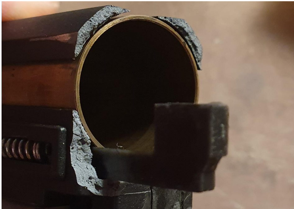
Obrázek 8 - Fatální poškození těla konstrukce s viditelným průřezem lomu
