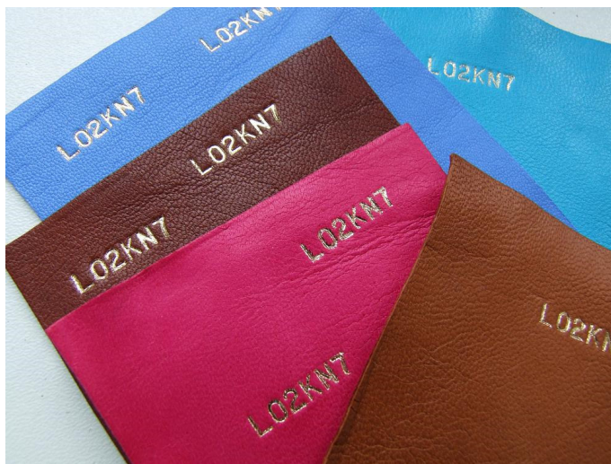
Obrázek 29: Značka vytvořená horkou ražbou [60]
