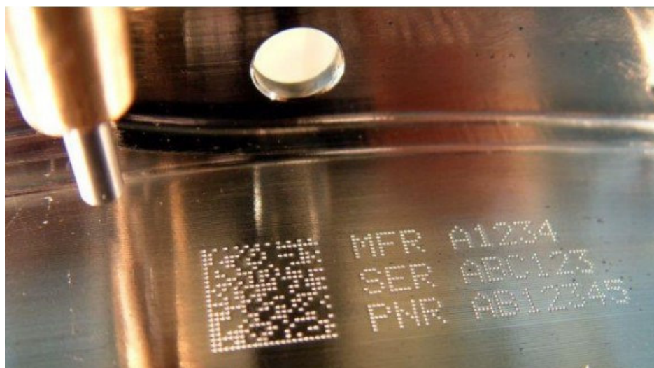
Obrázek 16: Označení ocelového dílu metodou mikroúderu [20]
