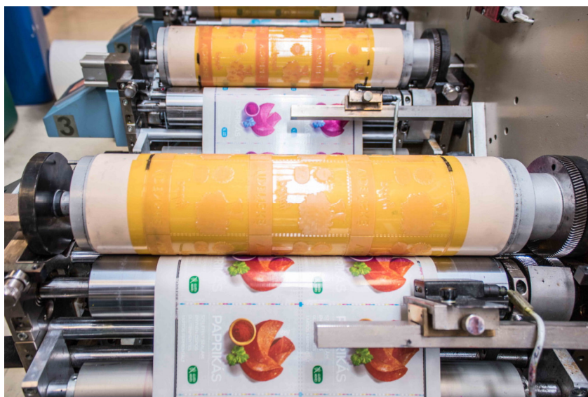
Obrázek 31: Etikety potištěné studenou ražbou [64]
