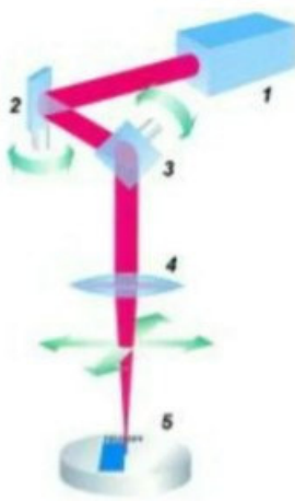
Obrázek 14: Princip popisování součásti vychylováním paprsku laseru
