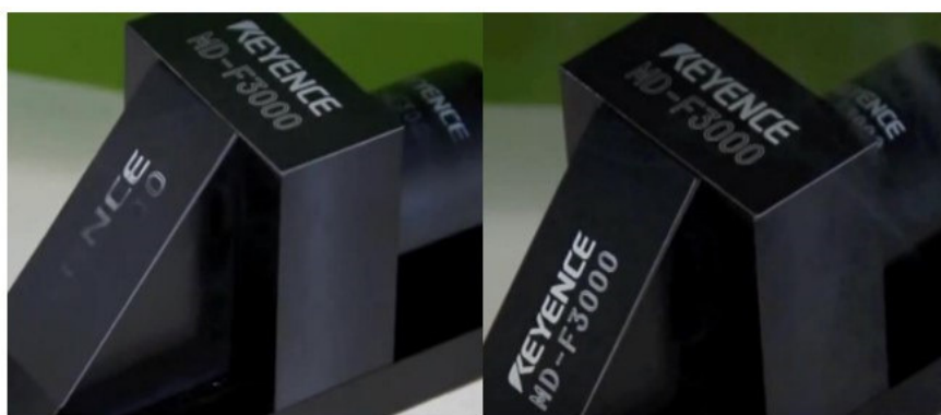
Obrázek 6: Rozdíl v označení 2D (vlevo) a 3D řízeného laseru (vpravo) [20]
