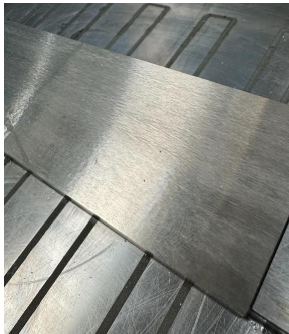
Obrázek 21: Výsledný povrch obráběné oceli po nevhodně zvolených řezných podmínkách
