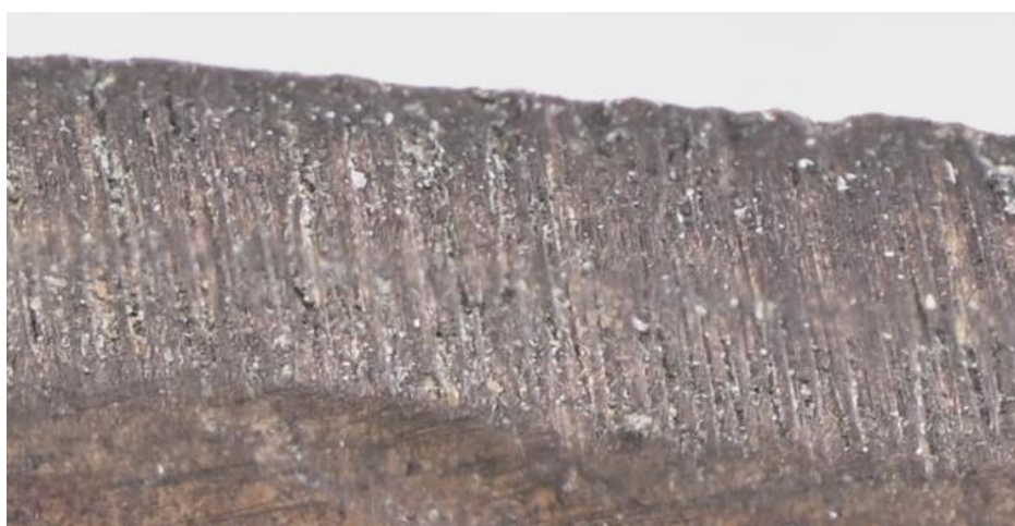
Obrázek 33 – Detail rozostřeného pruhu na břitu (Metoda A)
