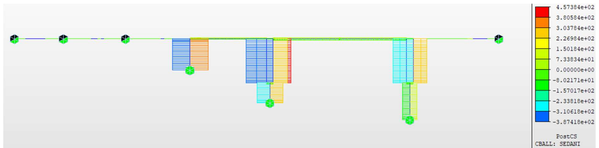
Obrázek 5.14 Obálka normálové síly N od sedání
