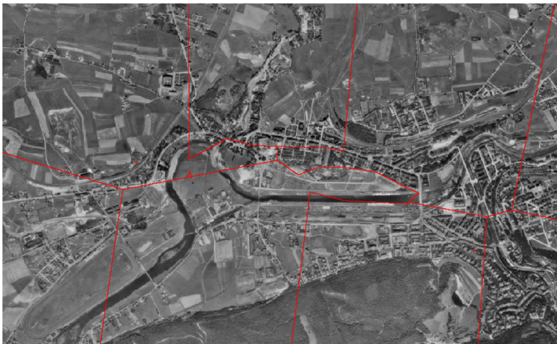
Obrázek 22: Ručně upravené linie sešití snímků na ortofotu Zdroj: vlastní
