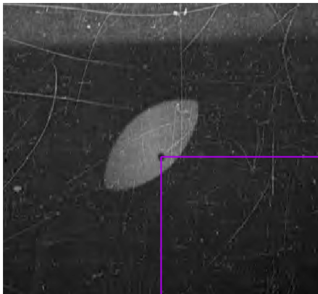
Obrázek 17: Ukázka a umístění rámové značky snímku Zdroj: vlastní
