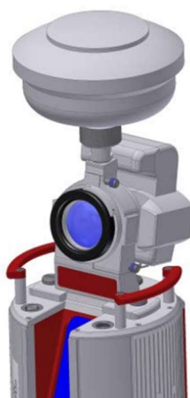
Obr. 9: Schéma nadstavby pro Riegl VZ-2000 [13]
