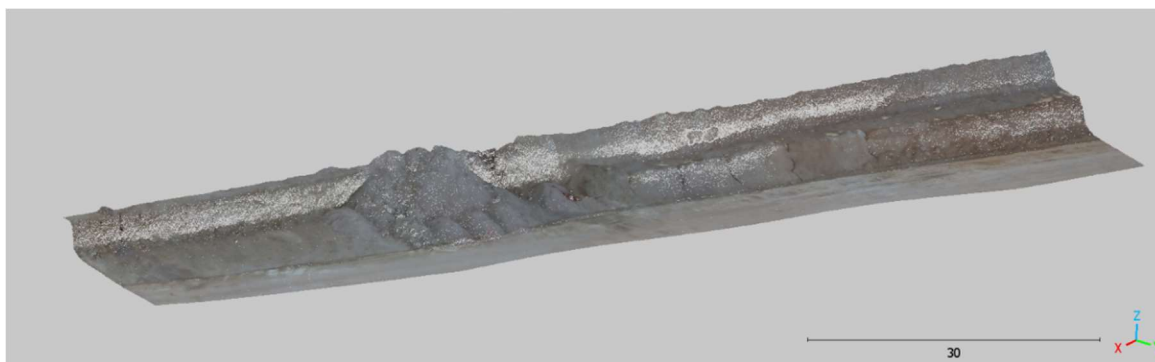
Obr. 28: Obarvené mračno bodů z UAV lidar měření
