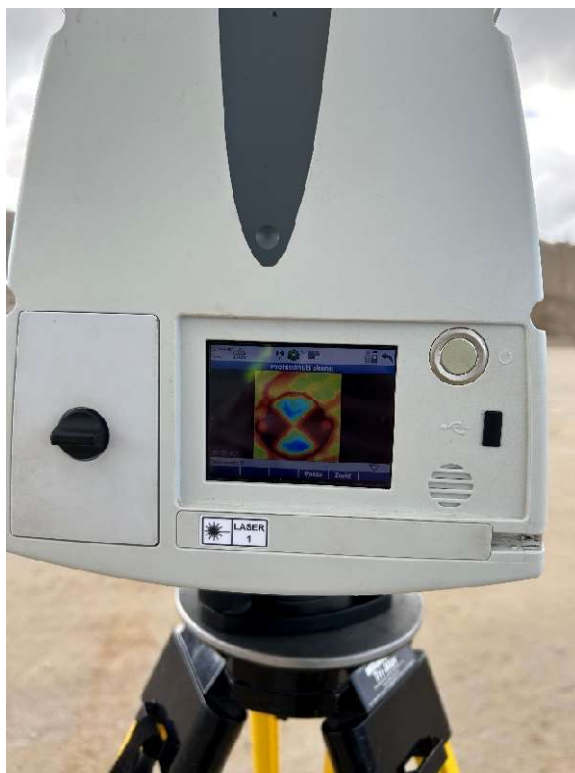
Obr. 22: Označování identických bodů na displeji skenovacího systému Leica P40
