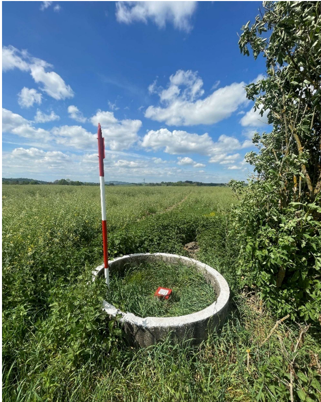
Obr. č. 2 - Stabilizace a ochrana trigonometrického bodu
