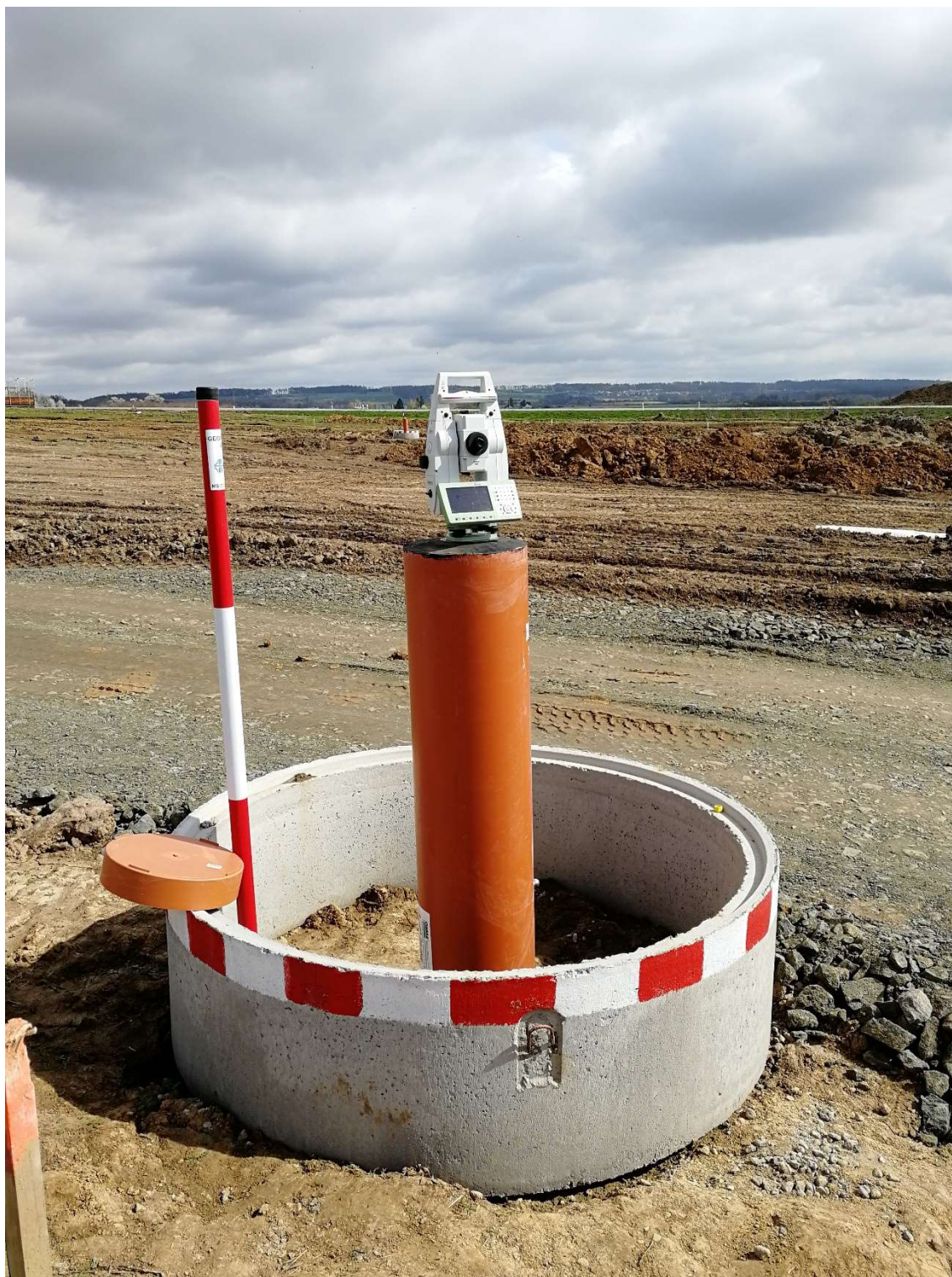
Obr. 5: Bod mikrosítě s totální stanicí (vlastní foto)
