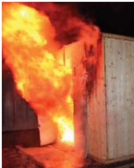
Obrázek 23 Požární zkouška místnosti: CLT na Carletonově univerzitě v Ontariu, Kanada
