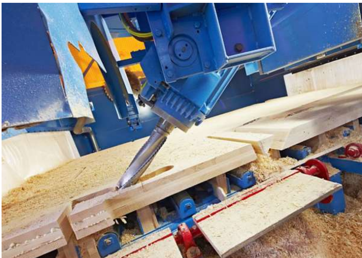
Obrázek 17: Stroj CNC vytváří otvory v panelu
