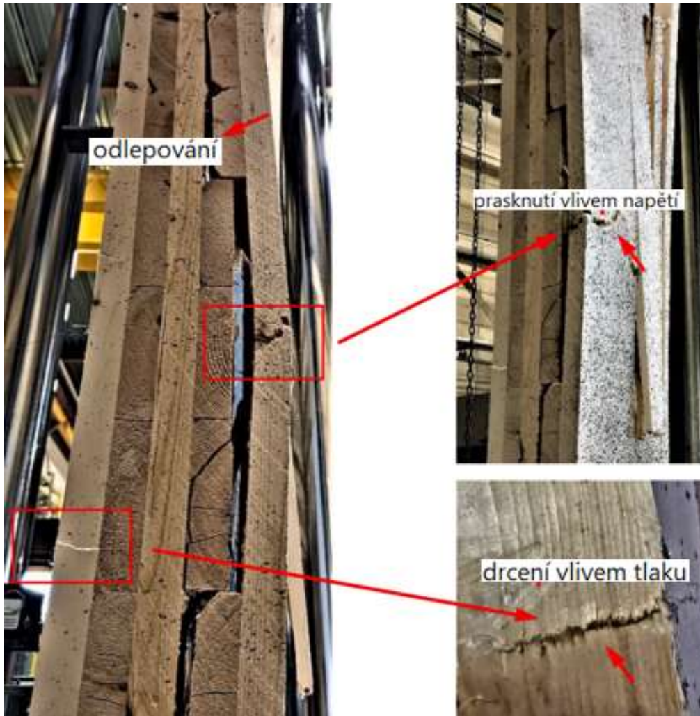
Obrázek 56: Typický způsob selhání
