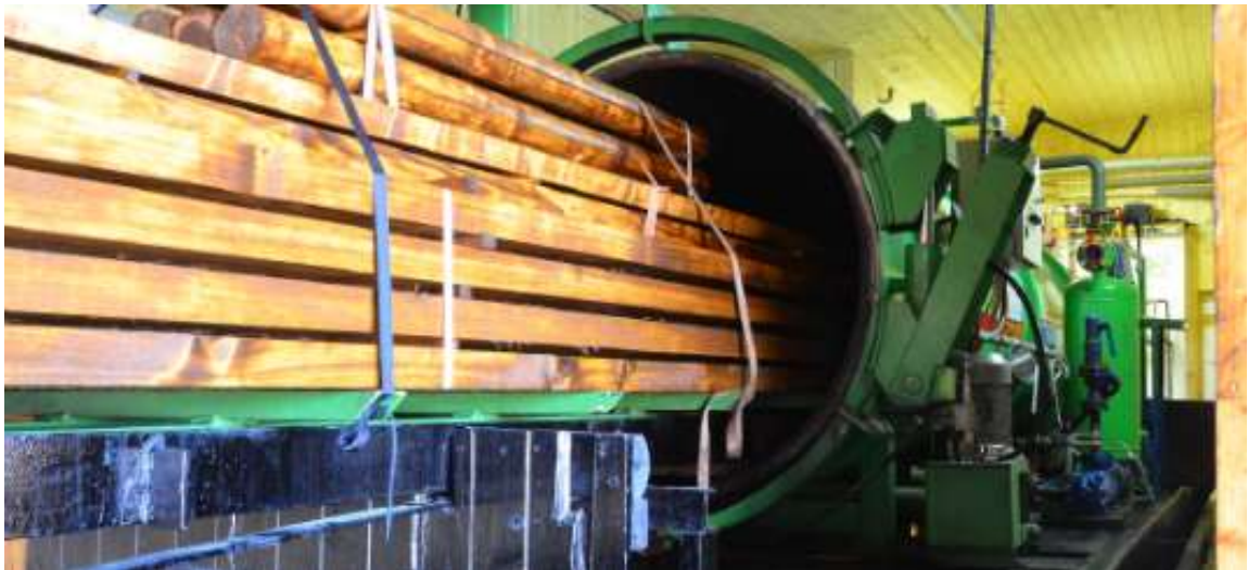
Obrázek 30: Tlaková impregnace dřeva
