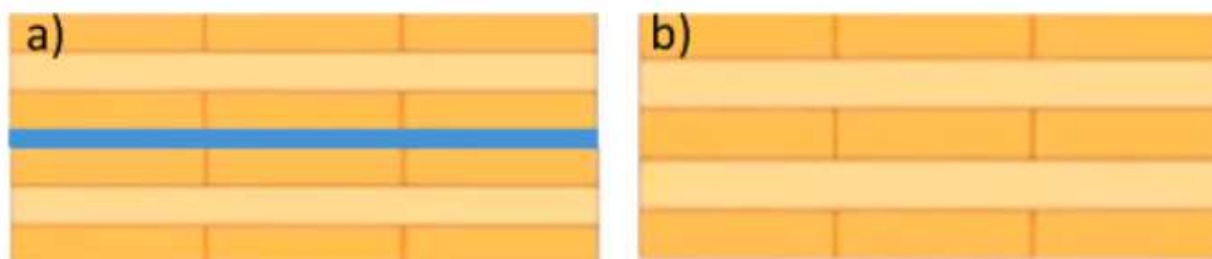
Obrázek 44: CLT podlahy k testování: a) těžké 2 × 60 mm 3-vrstvé panely s elastickou vrstvou mezi nimi a b) standardní 130 mm 5-vrstvý panel.
