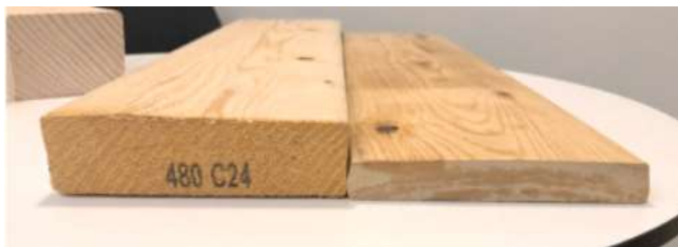
Obrázek 42: Původní prkno ze 38 mm smrku (vlevo) a identické prkno stlačené do desky o tloušťce 21 mm (vpravo).
