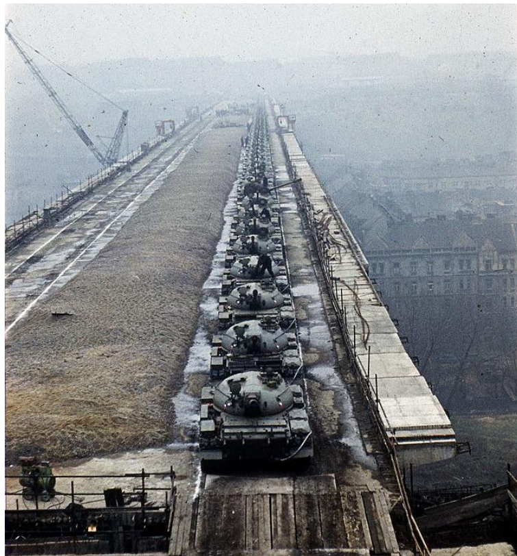
Obrázek 12 - Statická zatěžovací zkouška hrubé stavby mostu a 66 tanků s 3000 tunami říčního písku [12]
