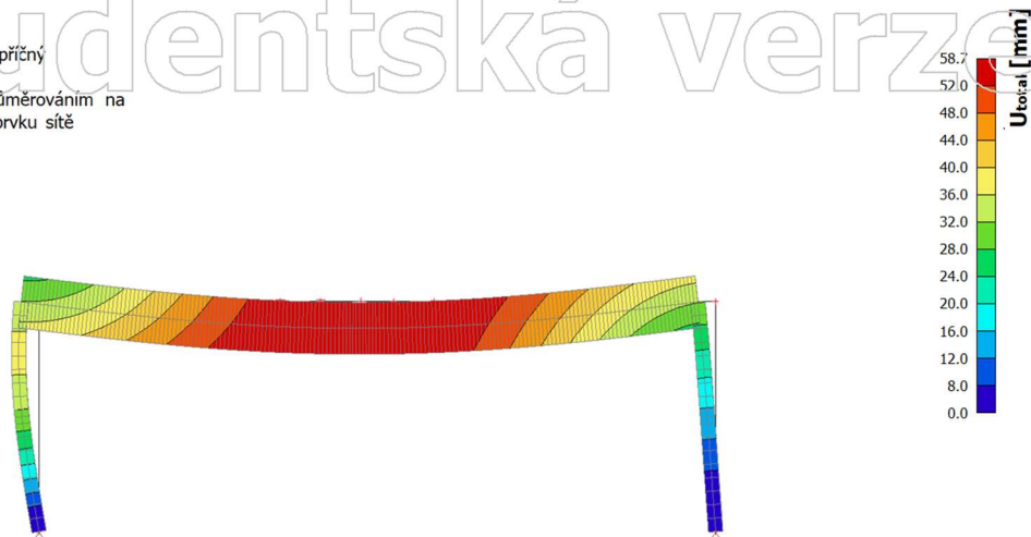
Obrázek 22: Maximální průhyb rámu - model
