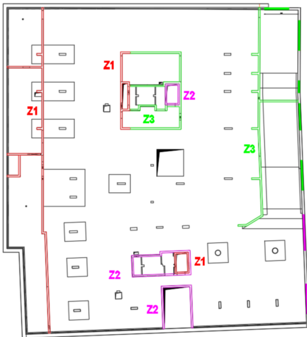
Obrázek 14: pracovní záběry stěn 3.PP
