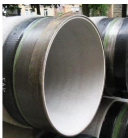
Obrázek 104: Potrubí s cementovou výstelkou [72]
