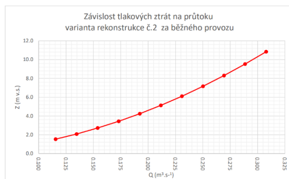
Obrázek 186: Graf závislosti ztrát na průtoku variant rekonstrukce č.2 DN 400
