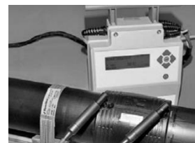
Obrázek 118: Svařování pomocí elektrospojky [44]
