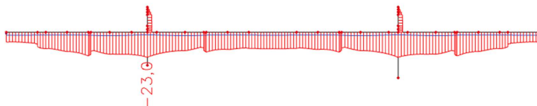
Obrázek 8-57: Maximální napětí v dolních vláknech od charakteristické kombinace v čase vnesení předpětí [MPa]
