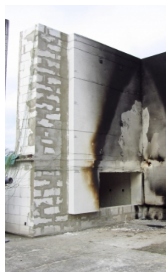
Obrázek 2-5 Průběh velkorozměrové požární zkoušky dle ISO 13785-2 [25]
