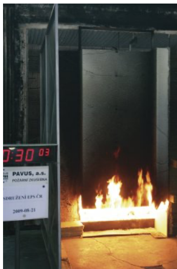
Obrázek 2-3 Ukázka ze středněrozměrové požární zkoušky dle ČSN ISO 13785-1 [15]
