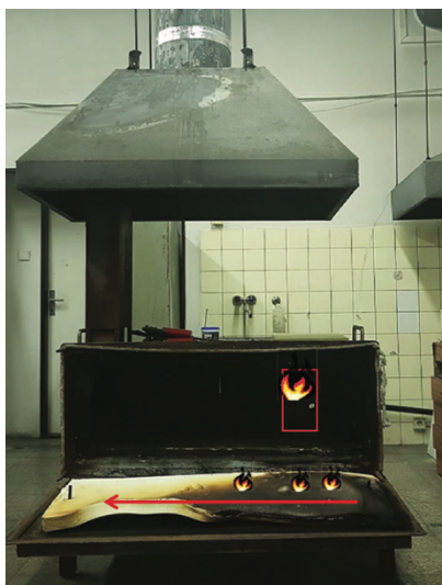
a) Fotografie po zkoušce pěnového materiálu pro obklad stěn (zdroj: fotoarchiv ČVUT)
