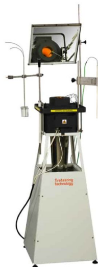
a) Zkouška nehořlavosti [7]
