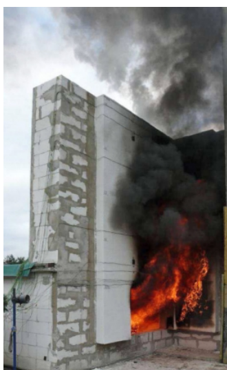
Obrázek 2-5 Průběh velkorozměrové požární zkoušky dle ISO 13785-2 [25]
