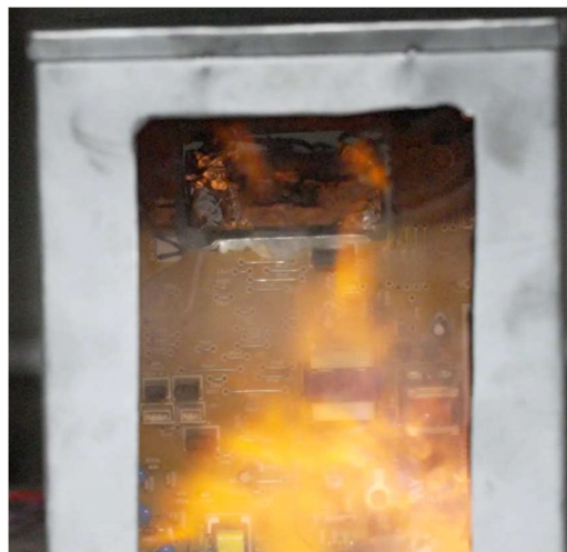
Obrázek 10 Moment opětovné iniciace po rozstříku kapaliny [7]
