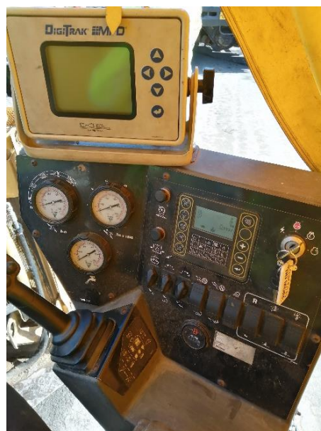
[Obr. 30] Řídicí centrum vrtného stroje [zdroj vlastní]
