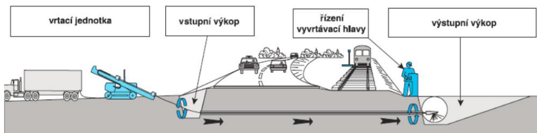
[Obr. 21] Schéma nasazení metody HDD [21]
