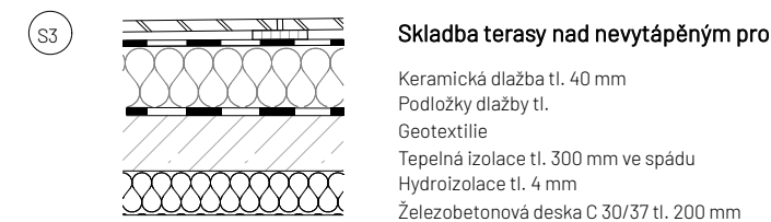
Skladba terasy nad nevytápěným prostorem
