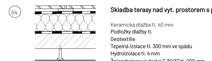
Skladba terasy nad vyt. prostorem s podhledem
