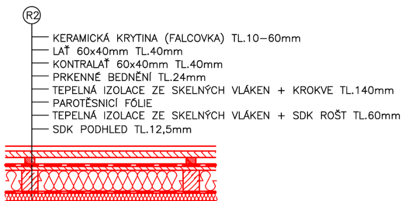
Obrázek 92: R2 – navržená skladba střešního pláště přístavku
