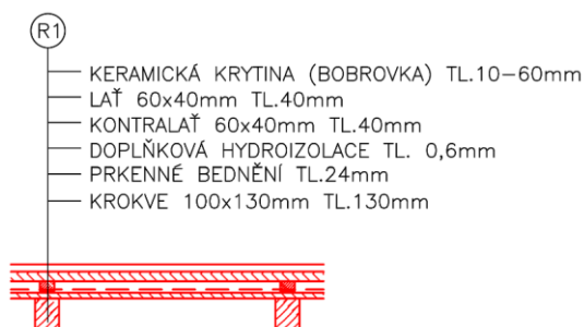
Obrázek 102: R1 – navržená skladba střešního pláště hlavní části
