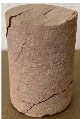
Obr. 2.46: Vzorka zohrievaná na 900°C
