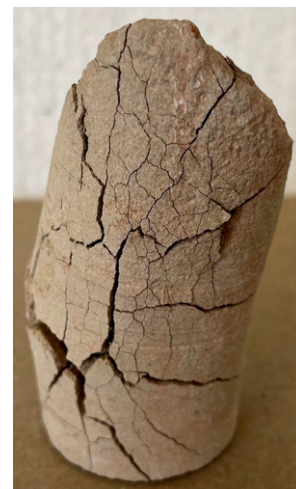
Obr. 2.47: Vzorka zohrievaná na 1060°C
