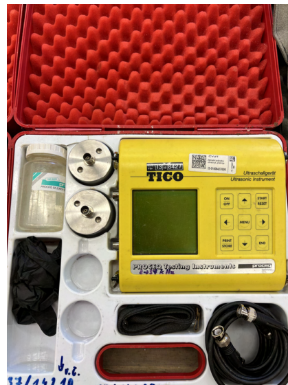
Obr. 2.15: Prístroj na meranie ultrazvukovej rýchlosti
