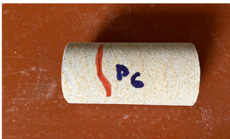
Obr. 2.5: Vzorka P6 s vyznačenou trhlinou
