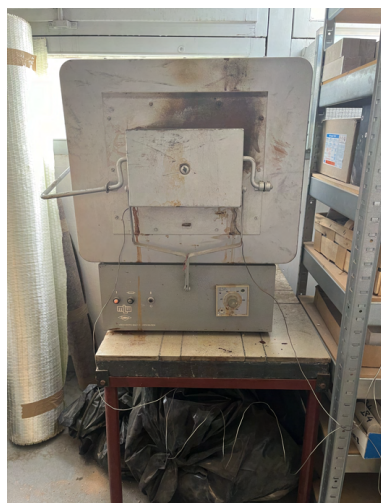
Obr. 2.9: Elektrická muflovacia pec
