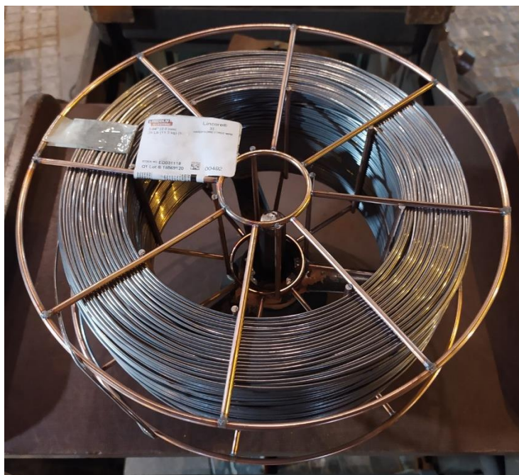
Obr. 66 - Cívka plněného drátu Lincoln 33 průměr 2,0 mm [Zdroj: Autor]
