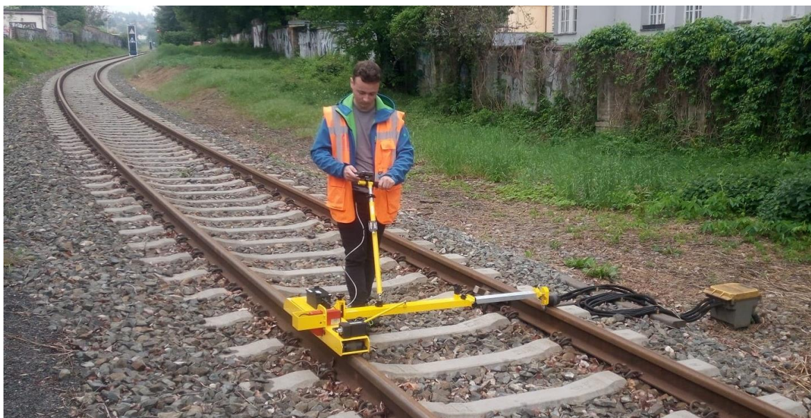
Obr. 80 - Měření s přístrojem Salamander [Zdroj: Ing. Ondřej Bret]
