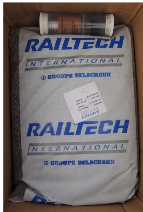
Obr. 45 - Termitová dávka Railtech [Zdroj: Ing. Ondřej Bret]
