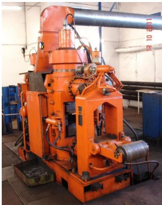
Obr. 58 - Modernizovaná svářečka K-190 PK Duchcovská svařovna [60]
