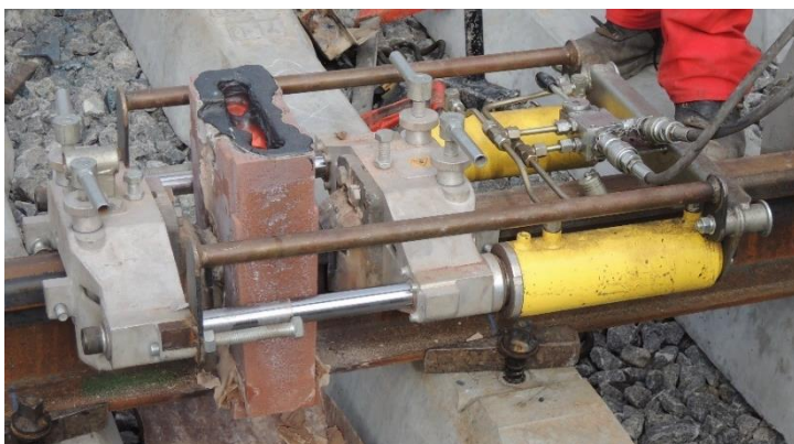
Obr. 55 - Hydraulická ořezávací jednotka [Zdroj: Ing. Ondřej Bret]
