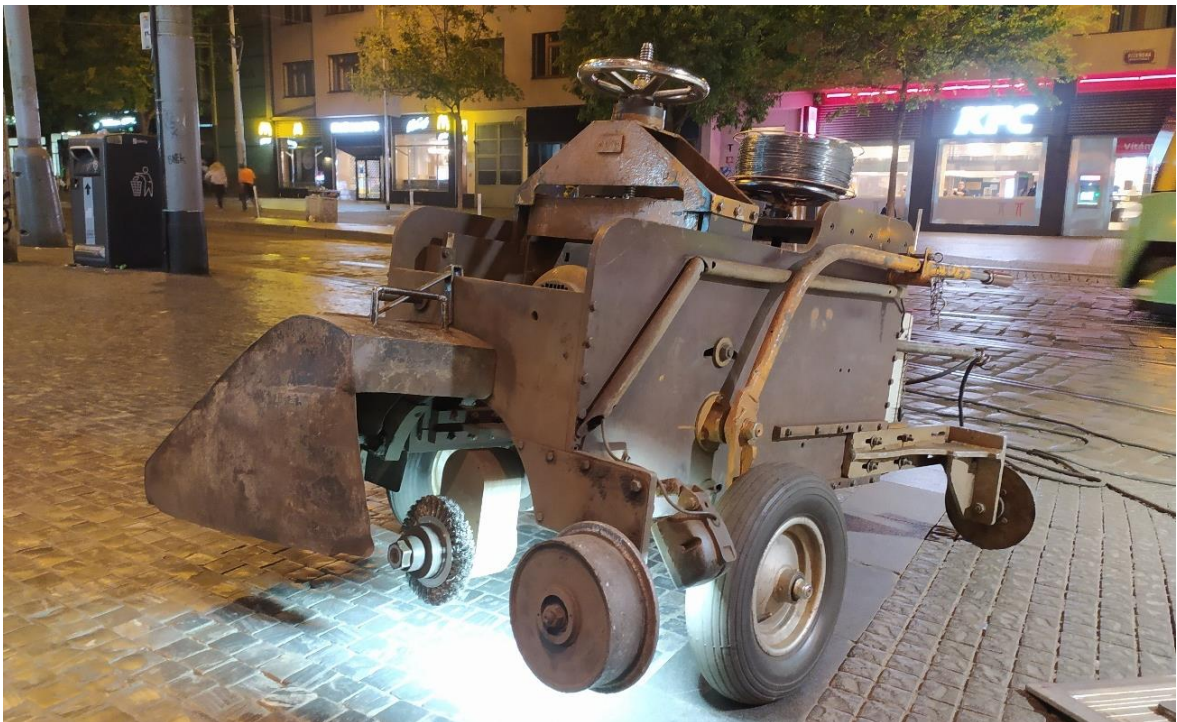
Obr. 69 - Brusný kolejový stroj pro vybroušení žlábků [Zdroj: Autor]
