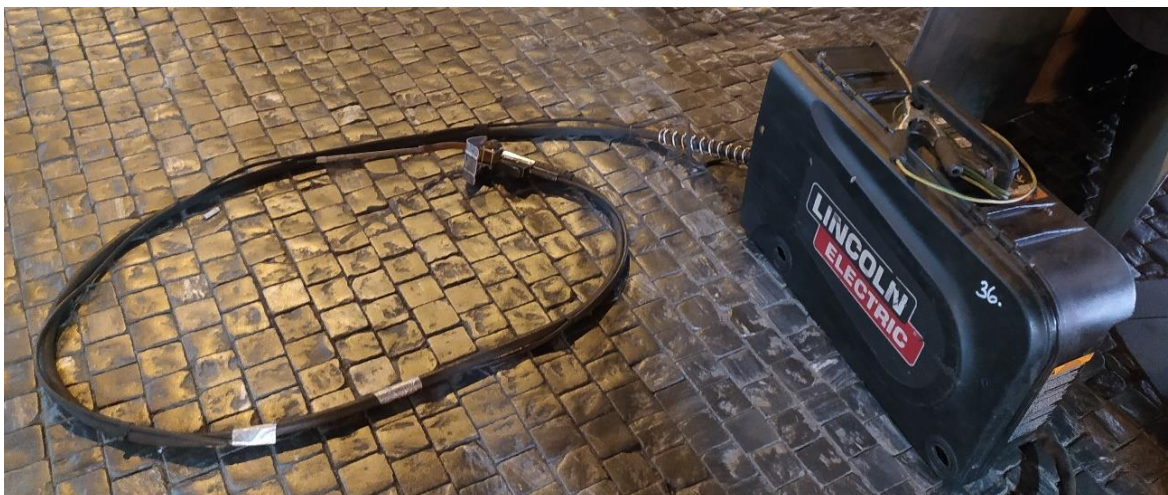
Obr. 65 - Svařovací pistole a podavač drátu Lincoln Electric [Zdroj: Autor]
