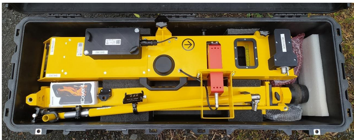
Obr. 70 - Rozložený měřicí vozík Salamander v přepravním boxu [Zdroj: Autor]
