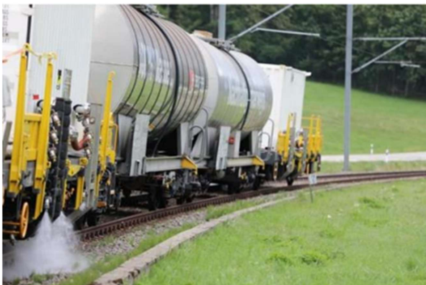
Obr. č. 30: Švýcarský prototyp horkovodního postřikovacího vlaku [5]
