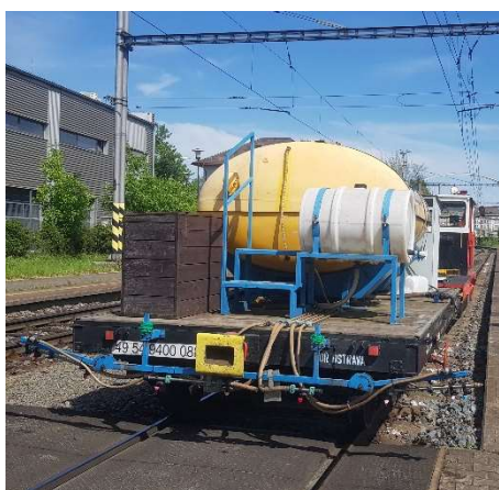
Obr. č. 8: Rám s proti-úletovými tryskami
