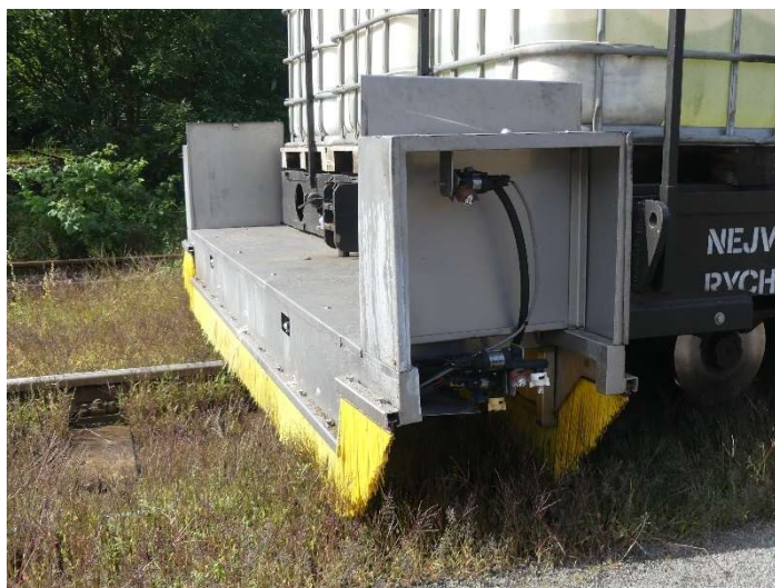
Obr. č. 12: Lišta s proti-úletovými tryskami
