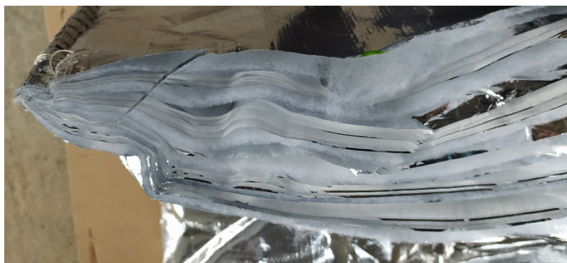
Obrázek 21: Detail vícevrstvé reflexní tepelné izolace. Zdroj: www.izolace-info.cz .
