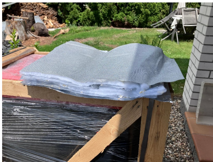
Obrázek 22: Paropropustná vícevrstvá izolace. Zdroj: interní foto firmy SuperFOIL.
