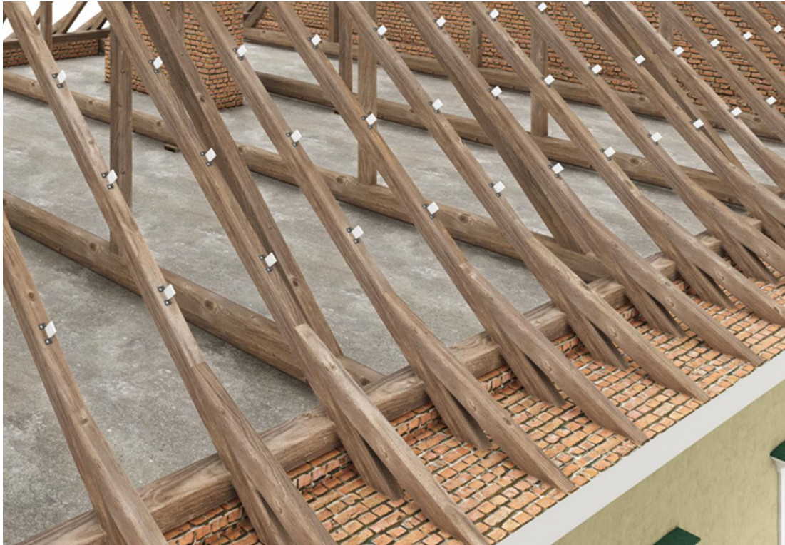
Obrázek 1: Schéma systému po montáži nosných botek na krokve
