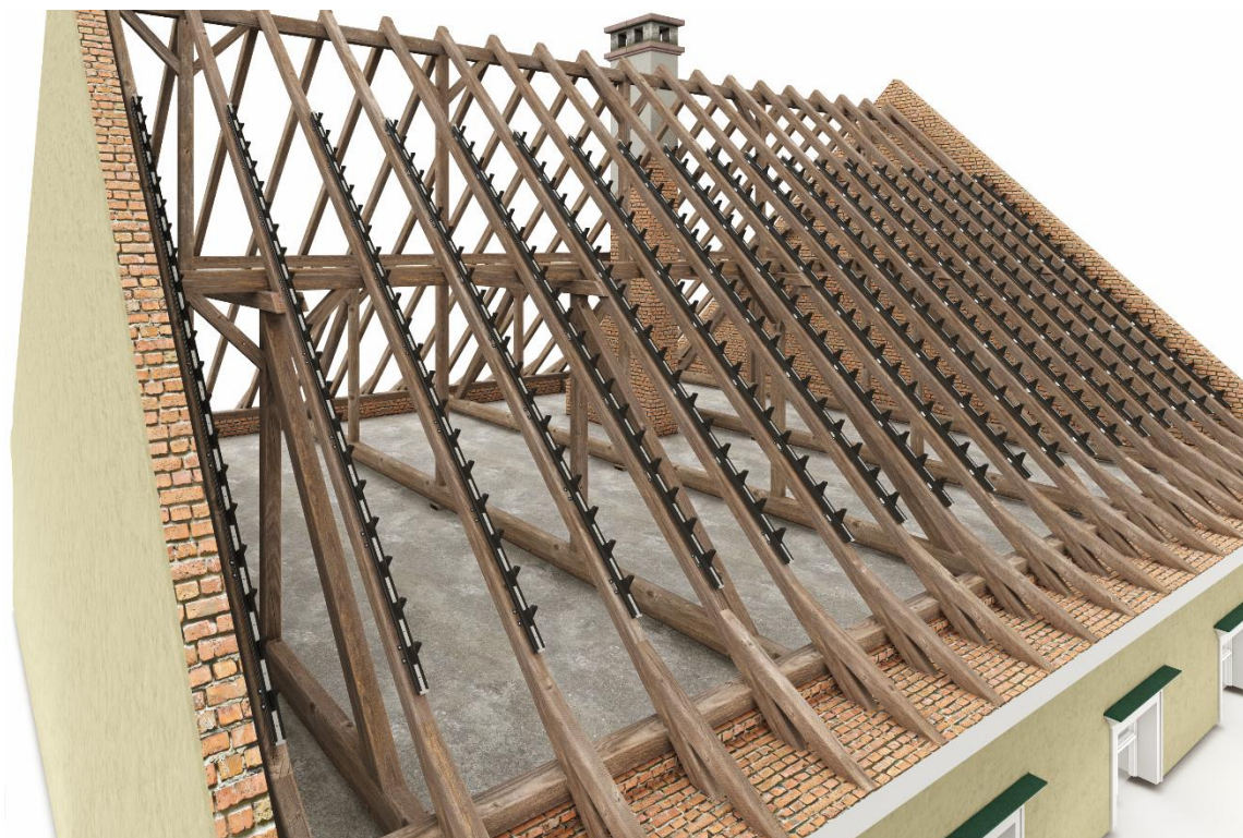
Obrázek 3: Schéma systému po montáži nosné konzoli
