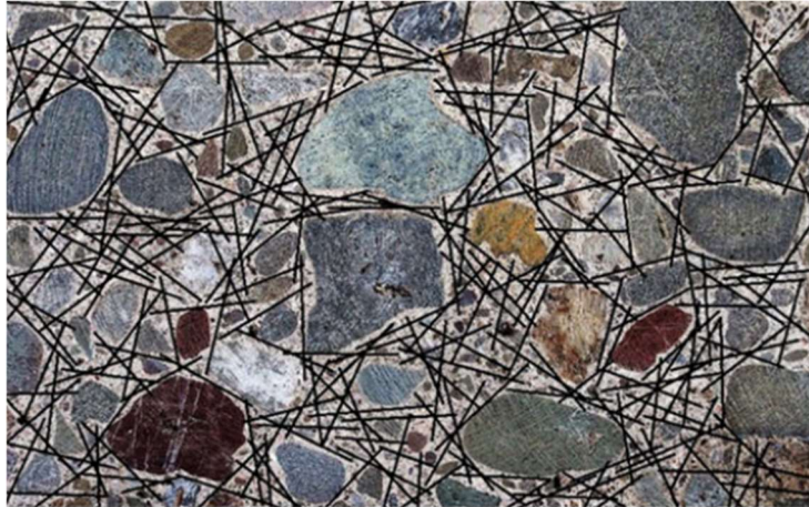
Obrázek 2 Drátkobeton znázorňující typické náhodné rozložení ocelových vláken v betonové směsi
