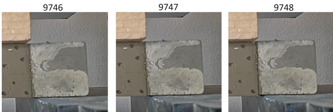
OBR. 36 PORUŠENÍ TĚLESA S VODOROVNÝMI DRÁŽKAMI V ROZHRANÍ
