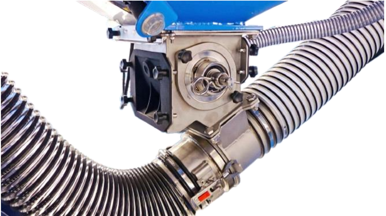
Obr. 22 - Dávkovací ústrojí secích strojů Farmet Falcon [14]
