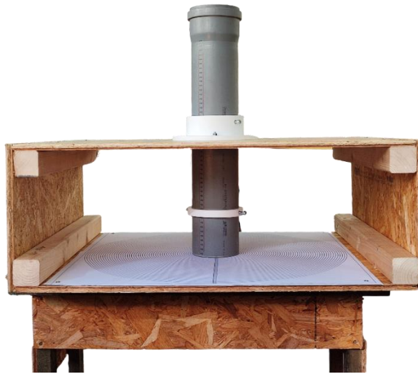
Obr. 39 - Přípravek na měření statického sypného úhlu
