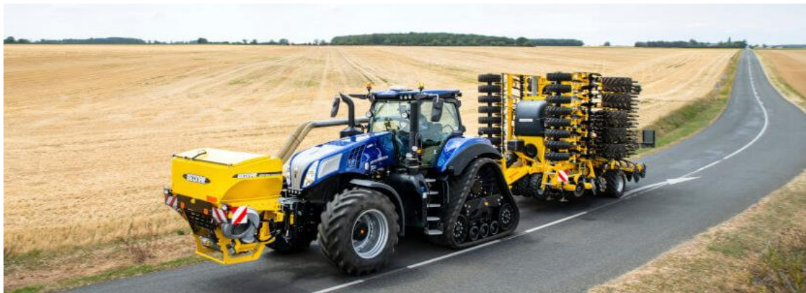
Obr. 42 - Polopásový traktor New Holland T8 s 9 m secím strojem OMEGA a přihnojováním z předně neseného zásobníku na hnojivo FERTI-BOX [26]
