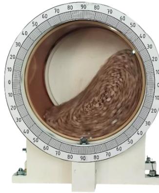
Obr. 41 - Měření dynamického sypného úhlu
