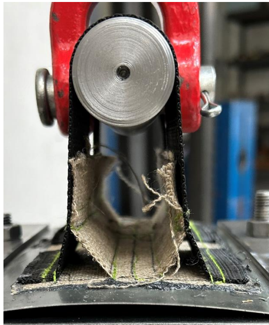
Obrázek 51 Závěs 03-02, v levé části lze vidět větší přetížení popruhu
