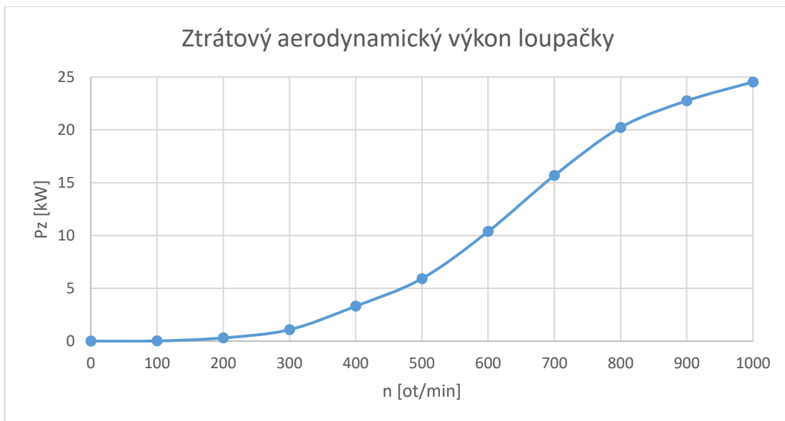
Obr. 81: Ztrátový aerodynamický výkon loupáčky s lopatkami 80 mm
