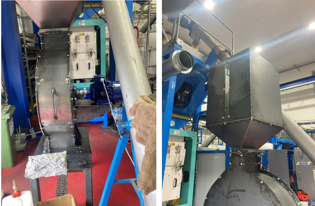
Obr. 103 Vyrobený stand pro verifikaci CFD a DEM výpočtů 2
