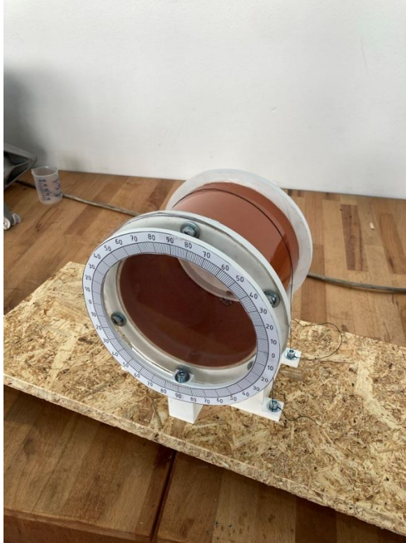
Obr. 57: Stand na měření dynamického sypného úhlu
