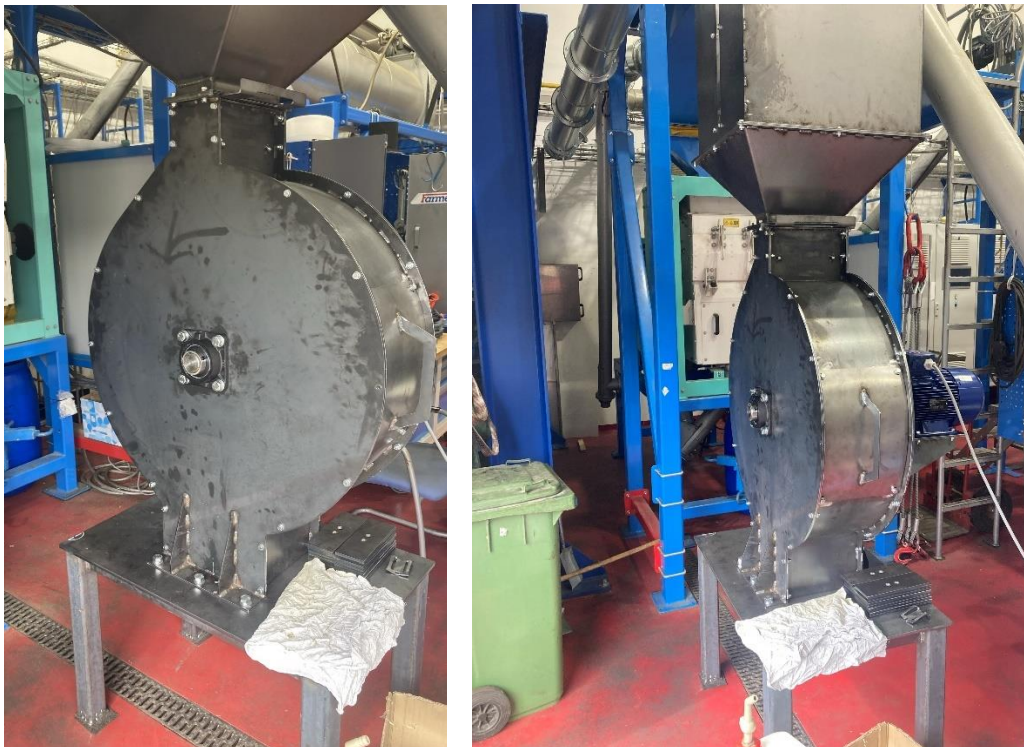
Obr. 102: Vyrobený stand pro verifikaci CFD a DEM výpočtů
