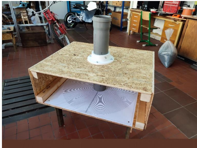
Obr. 51: Stand na měření statického sypného úhlu
