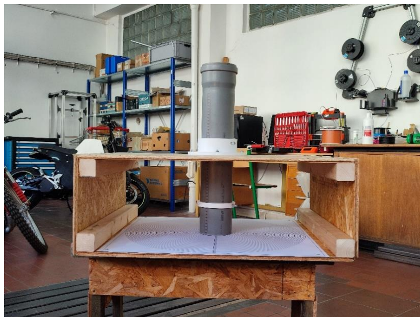
Obr. 52: Stand na měření statického sypného úhlu 2
