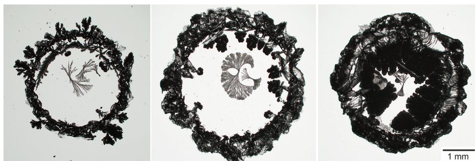
Obrázek 3.18: Morfologie krystalů síranu sodného vykrytalizovaných v podmínkách 40 °C, 60 °C a 100 °C a RV < 20 %.
