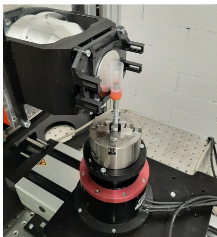
Obrázek 2.15: Uspořádání měření testovacích válečků v rentgenovém tomografu.
