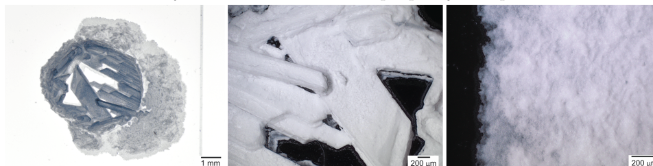
Obrázek 3.22: Krystalizace síranu sodného při pokojové teplotě a RV 55 %.
