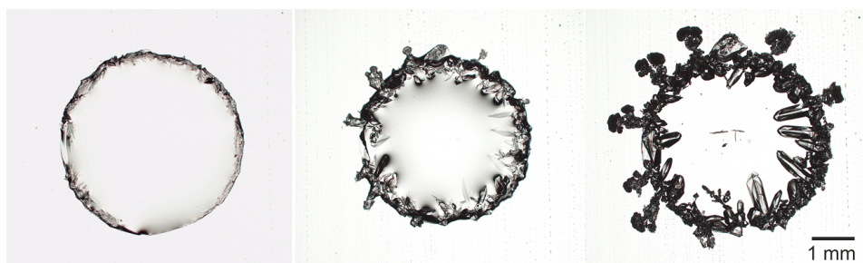
Obrázek 3.22: Krystalizace síranu sodného při pokojové teplotě a RV 55 %.
