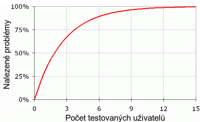
■ Obrázek 4.1 Nielsenova křivka použitelnosti, která zachycuje vztah mezi počtem testovaných uživatelů a nalezenými problémy. [32]
