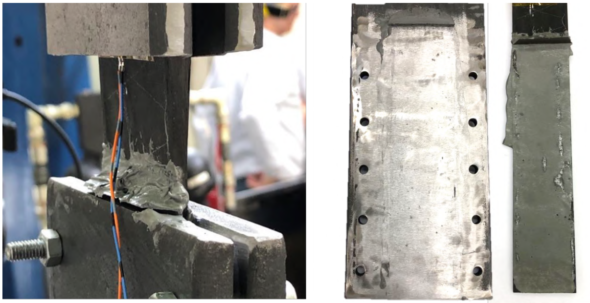
Obr. 44: Vytržení vzorku z přípravku, vlevo: detail vytržení během zkoušky zkoušce, vpravo: stav povrchu vzorku a přípravku po vytržení
