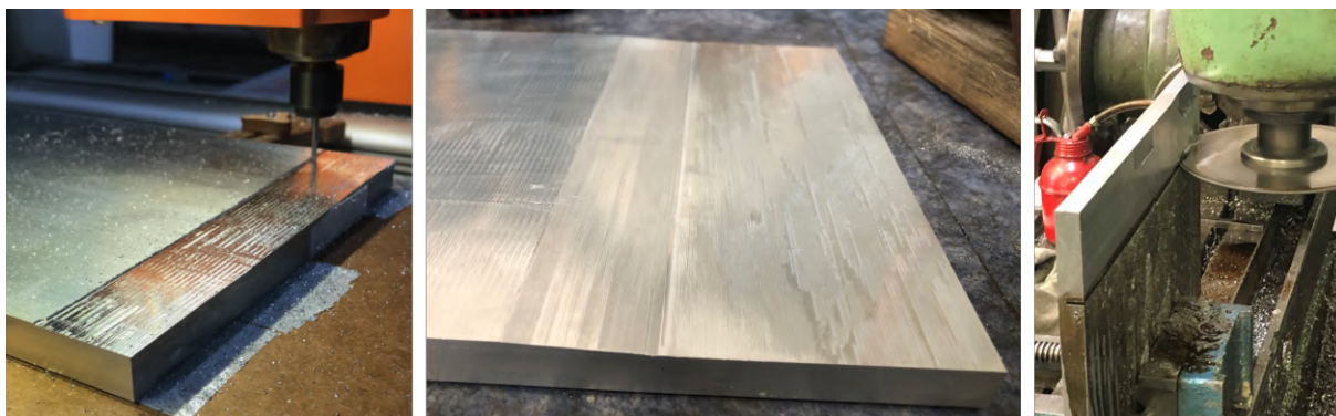
Obr. 37: Frézování čela formy a řezání boční stěny
