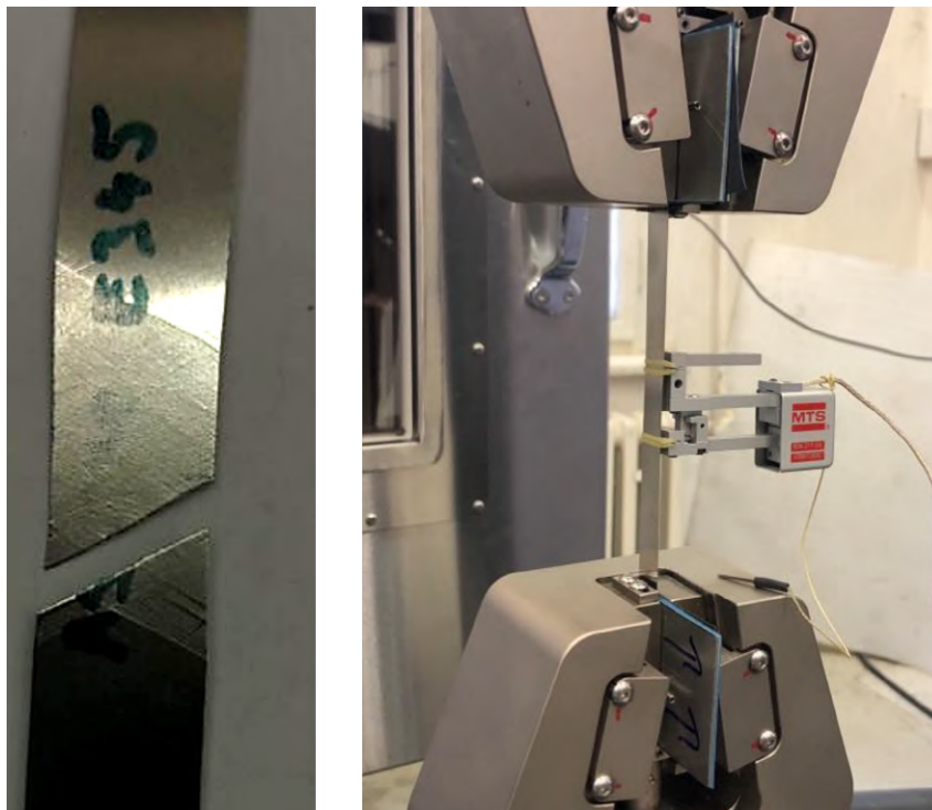
Obr. 12: vlevo - přetržený vzorek č. 4, vpravo - měřicí aparatura
