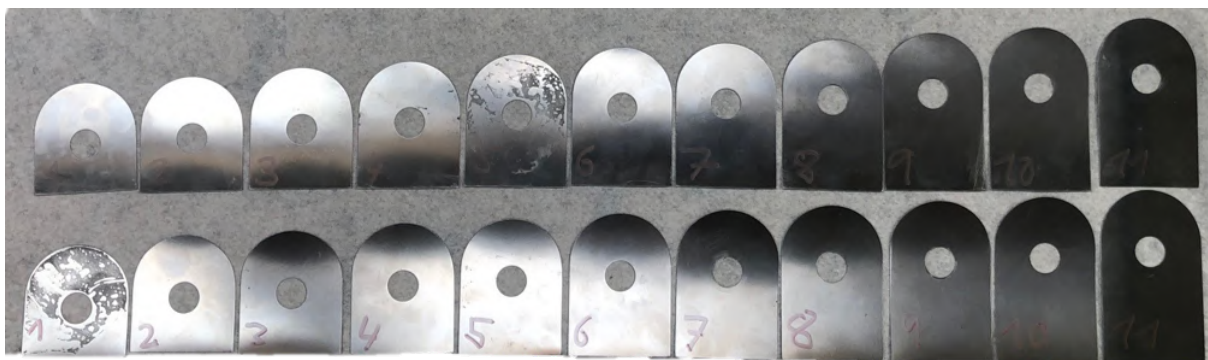
Obr. 39: Ocelové plechy vyříznuté vodním paprskem
