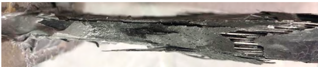
Obr. 49: Boční pohled na porušený vzorek 2
