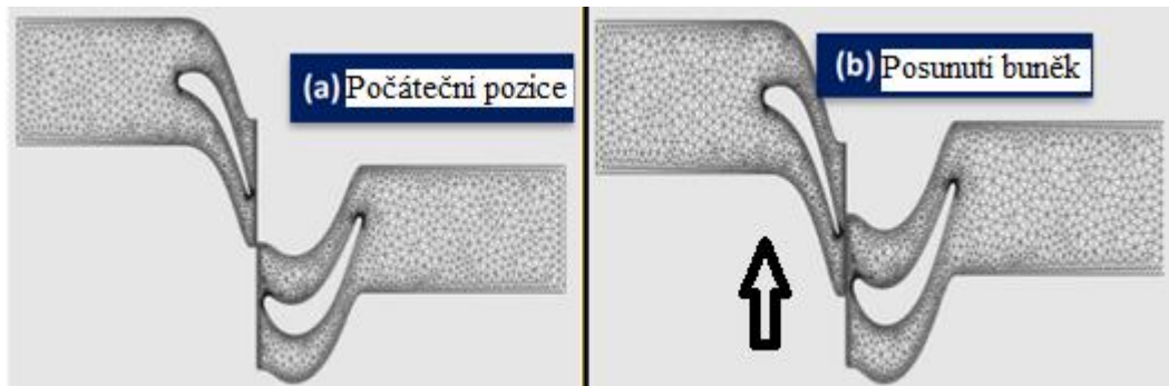
Obr. 6 Technika Sliding Mesh, (a) Počáteční pozice, (b) Posunutí zóny buněk [4]
