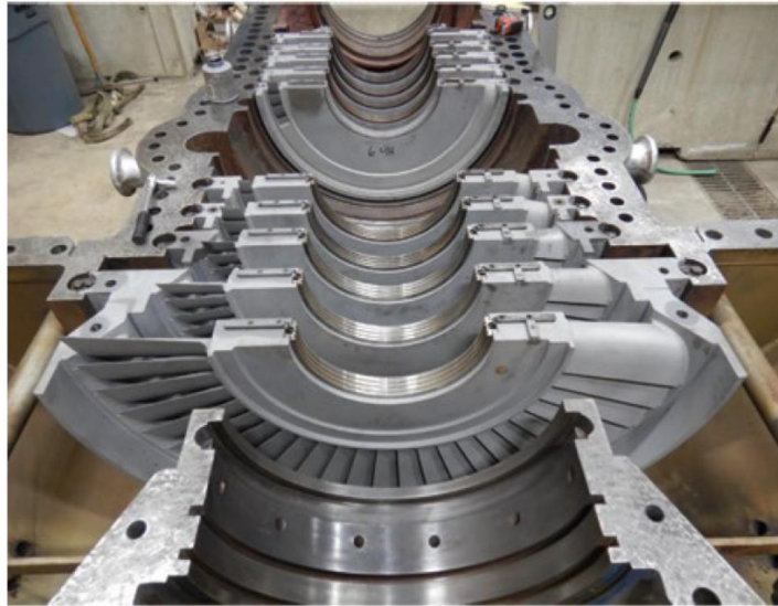
Obrázek 3 - Ukázka usazení lopatek v mezistěných [13](UPRAVENO)
