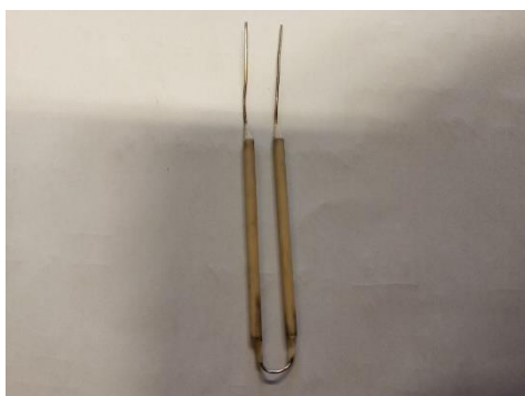
Obrázek 37 - Výsledná podoba systému pro celkový ohřev
