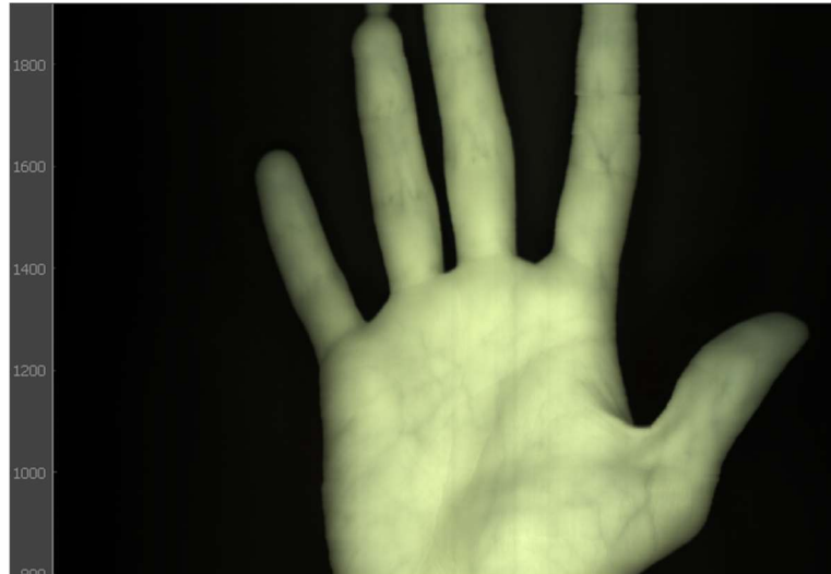
Obr. 4.10 - Snímka ruky v rozsahu vlnových dĺžok 750-1000 nm (blízka infračervená oblasť)
