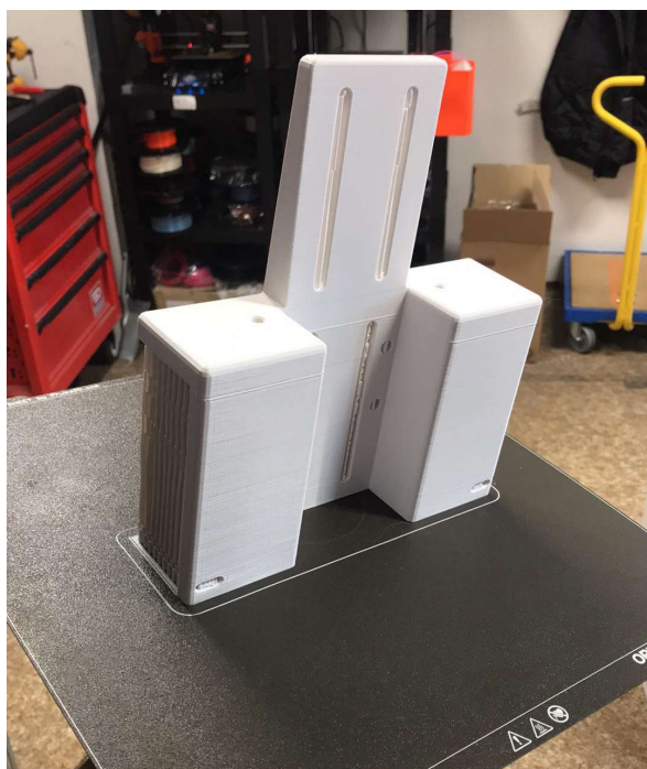
Obr. 3.3 - Držiak kamery. Finálny produkt. Kamera bude do držiaku uchytená pomocou skrutiek M5x15 a bude ju možné posúvať.
