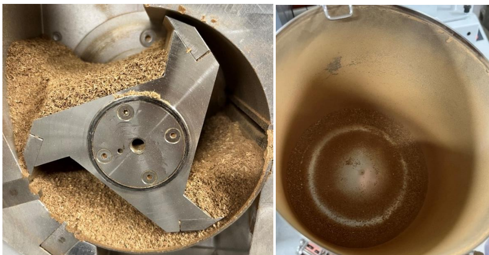
Obrázek 22 Ucpaný rotor při 500 rpm a 0,75 mm sítu, nevznikl žádný reprezentativní vzorek
