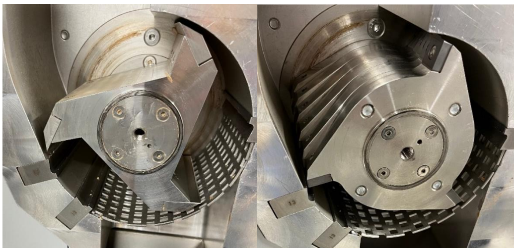
Obrázek 15 Paralelní rotor (lineární 3 břity) a 6-diskový (šroubovicový) rotor
