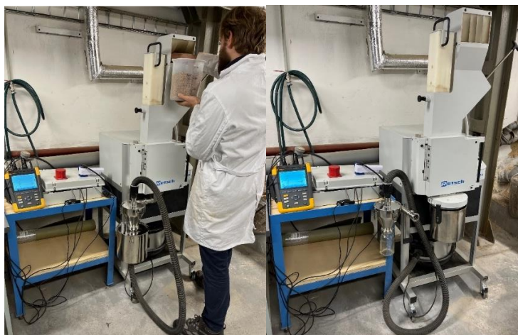
Obrázek 17 Mlýn Retsch SM 300 v konfiguraci pro mletí s podtlakem (vlevo) a bez podtlaku (vpravo)
