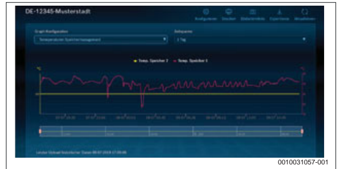
obr. 45 Control Center CommercialPLUS: Graf; Zobrazení zaznamenaných datových bodů. Aktualizuje každých 6 hodin automaticky nebo okamžitě ručně. Maximální doba archivace: 2 roky, rozlišení: 0,5° kroku; až max. 125 datových bodů
