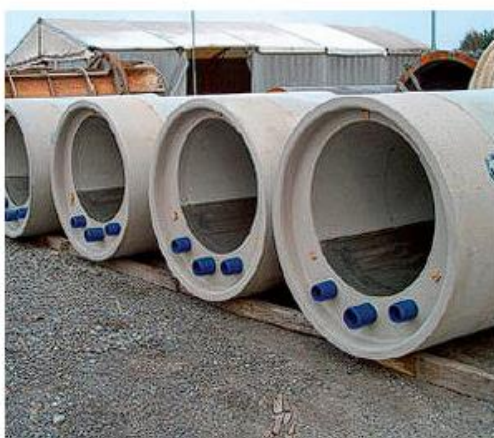
Obr. 9-7 Výměník zakomponovaný do segmentu kanalizační stoky [15]
