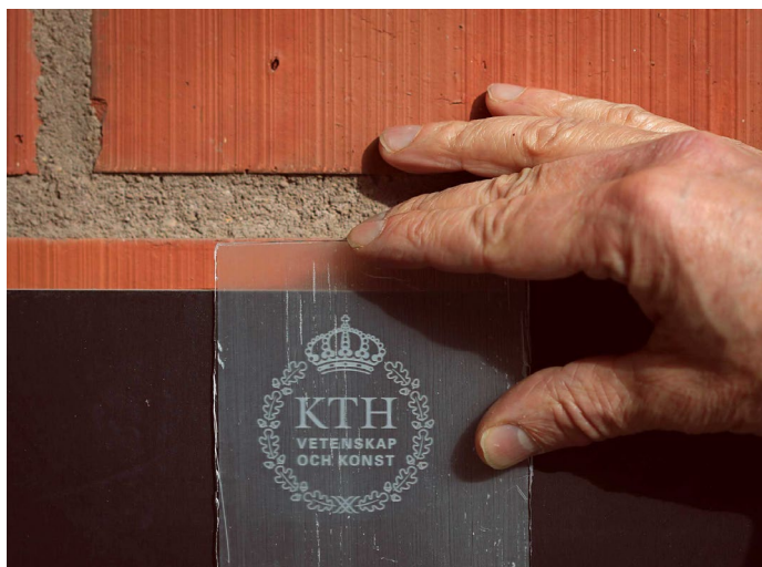
Obr. 34 - Vzorek transparentního dřeva, © University of Maryland & KTH Royal Institute of Technology
