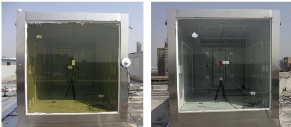
Obr. 29 - Žluté zbarvení thermochromického skla, převzato ze studie J. Vlčka, ZČU
