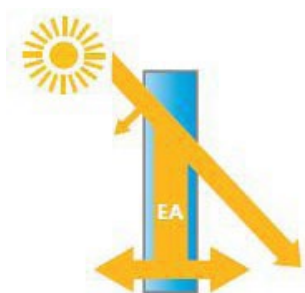
Obr. 23 - Absorpční sklo, převzato z příručky AGC
