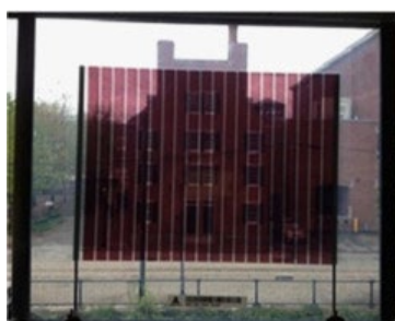
Obr. 40 - Organické solární články, převzato z článku F. Yan, 2013
