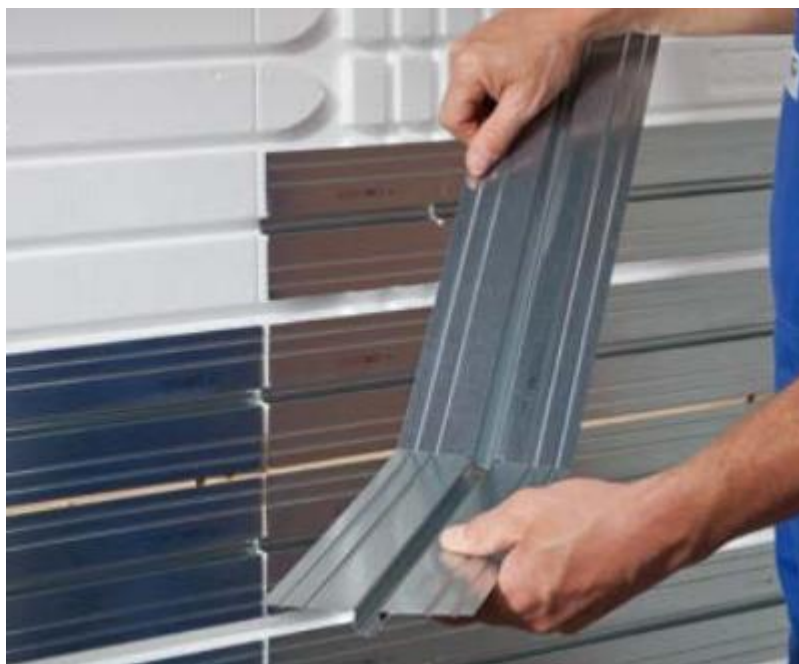
Obr. 9 Zkracování plechové lamely [7]
